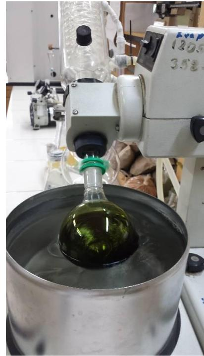
Figura A- 7. Mezcla de filtrados en el rotaevaporador.
