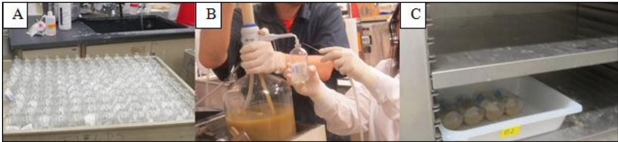
Figura 6: Determinación de la digestibilidad in vitro de la materia seca (A) Muestras (B) Adición de líquido ruminal y CO 2 (C) Incubación
