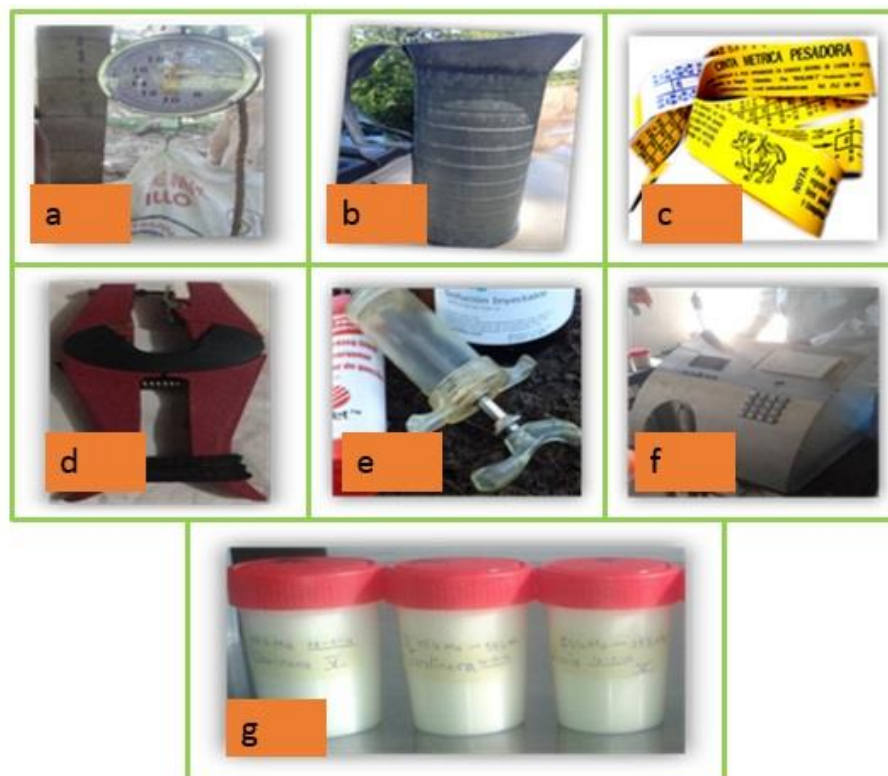
Figura 2. Equipo utilizado en la investigación. a) Báscula de reloj, b) medidora de leche, c) cinta barométrica, d) aretadora, e) jeringas, f) lactoscan y g) frascos plásticos.
