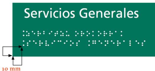
Figura 4.34. Señal con ambos sistemas de lectoescritura. El sistema braille se ubica en la zona inferior izquierda y a 10 mm de los márgenes.
