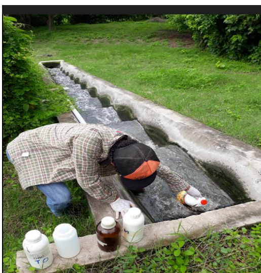
Figura 21. Muestreo del agua residual en las gradas de aireación.
