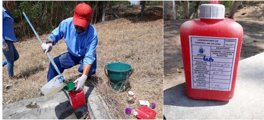
Figura 12. Muestreo realizado por personal de ANDA en efluentes de la Planta de Tratamiento.
