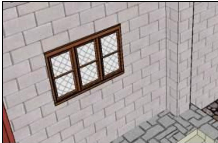
Figura No. 132 Muestra las zarandillas de retención de insectos en las ventas.
