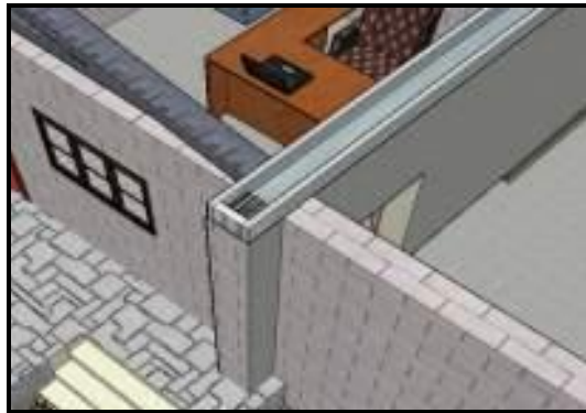
Figura No. 131 Las bajadas de aguas lluvias serán como se muestran en la figura.
