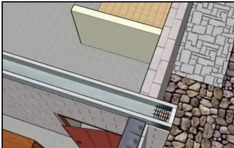
Figura No. 130 Muestran canaletas para la recepción de aguas lluvias
