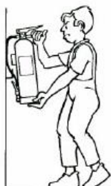
Ilustración 20. Descolgar el extintor
