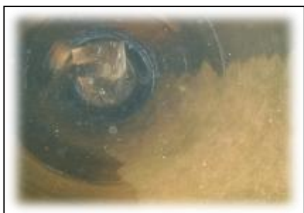
Ilustración 13 a). Separación de cristales de Sacarosa de la moledura por centrifugación.
