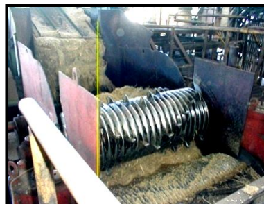
Ilustración 7. Fase de Molienda (Extracción del jugo) de la caña en los molinos.
