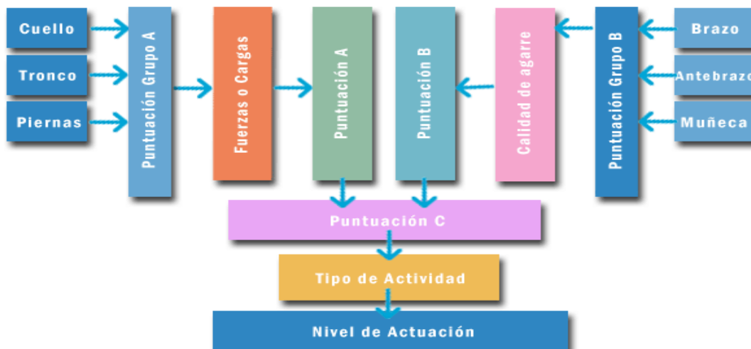
Ilustración 52 Esquema de puntuaciones REBA
