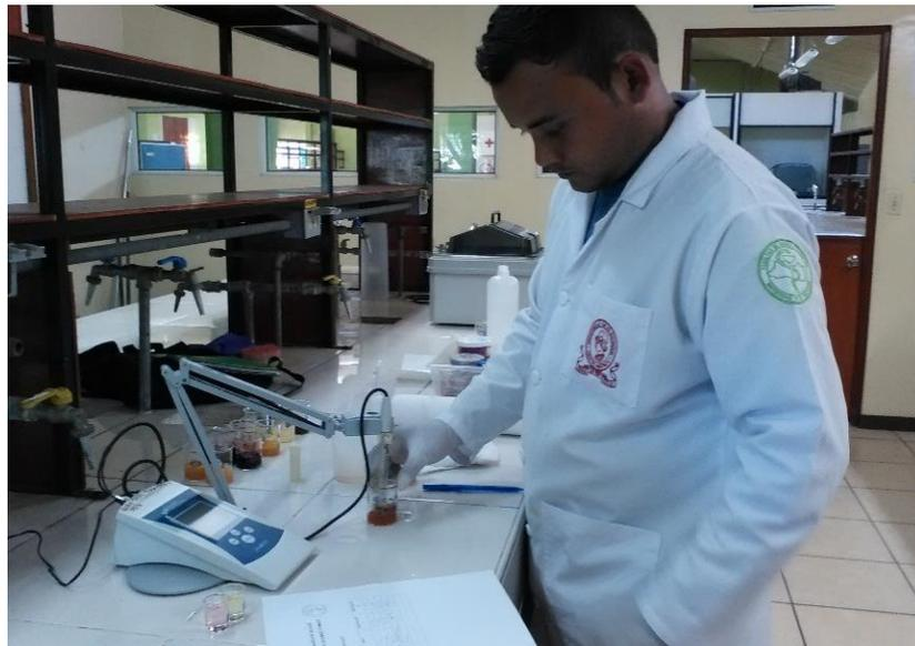
Figura N°17. Proceso de lectura de pH utilizando el pHmetro marca Denver Instrument modelo 250.
