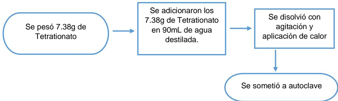
Figura N°11. Esquema de preparación de Tetrionato
