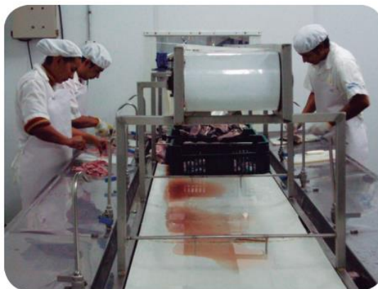
Figura N° 4: Superficie de trabajo construido de material de fácil limpieza (12) .
