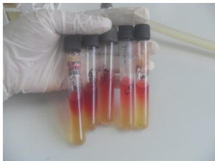
**Figura N° 24.** Prueba positiva de Rojo de metilo
