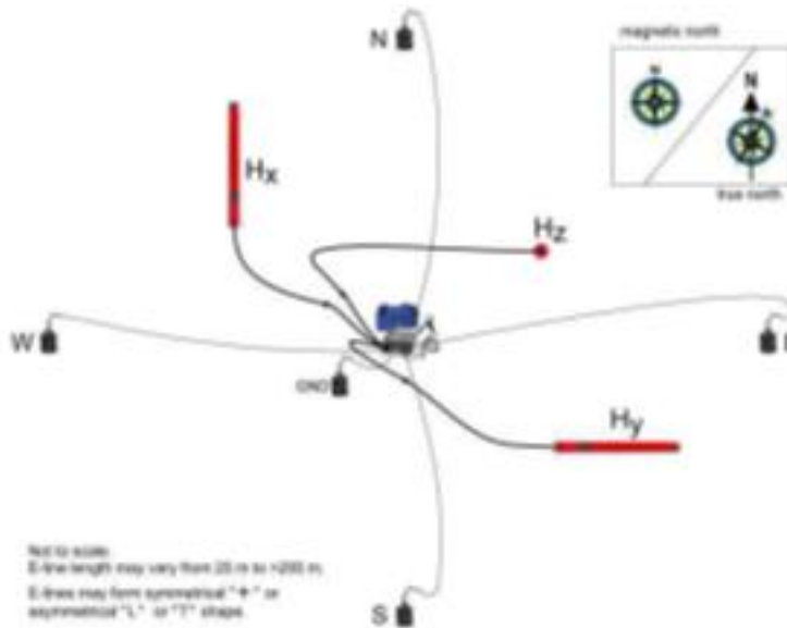
Figura 6. Arreglo geométrico del equipo MT, en campo
