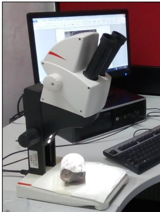
Figura 17.- Descripción macroscópica en lupa con aumento de x10, x20 y x40.
