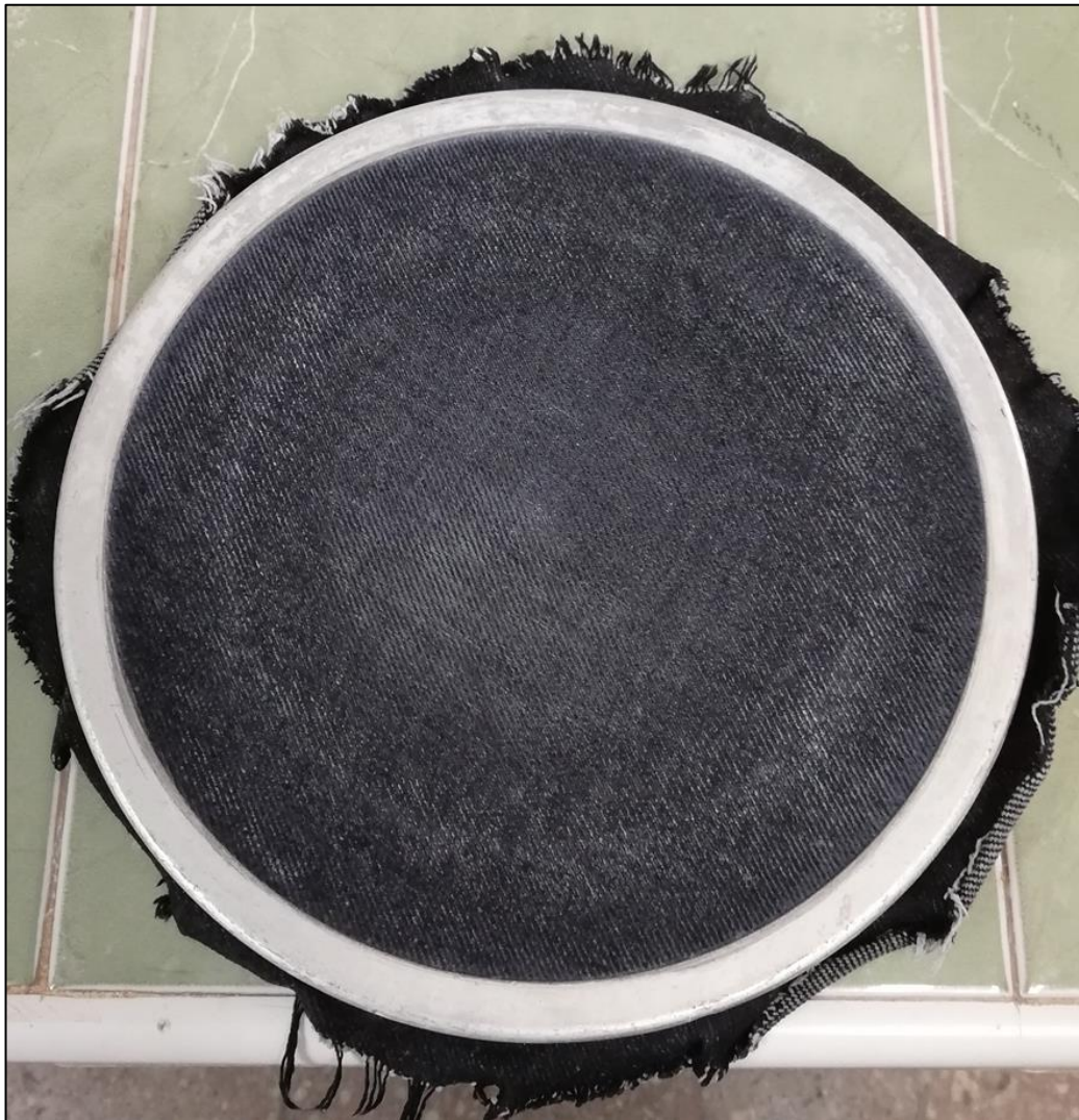
Figura 21.- Disco de la pulidora debe ser cubierto con lona (mezclilla).
