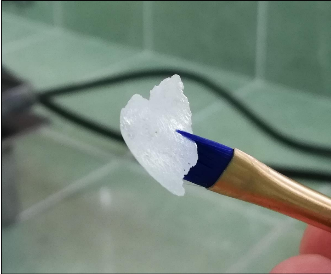
Figura 26.- Lamina delgada con doble pulido o chip ya terminado.
