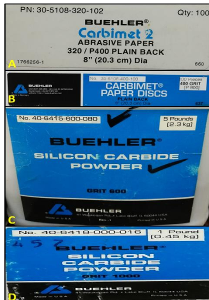
Figura 20.- Muestras de abrasivos marca y numero de grid que se usan.
