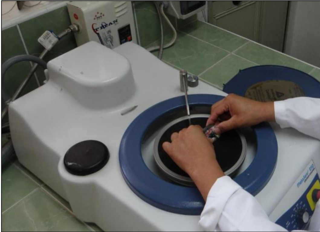
Figura 19.- Desgaste de muestra.
