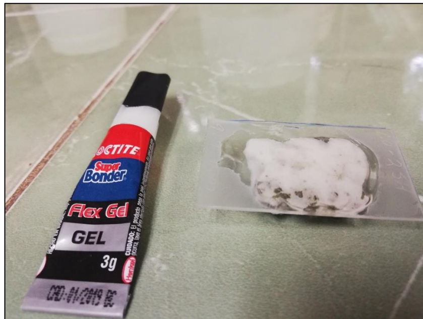
Figura 24.- cementante utilizado y muestra pulida adherida al vidrio para lámina delgada.
