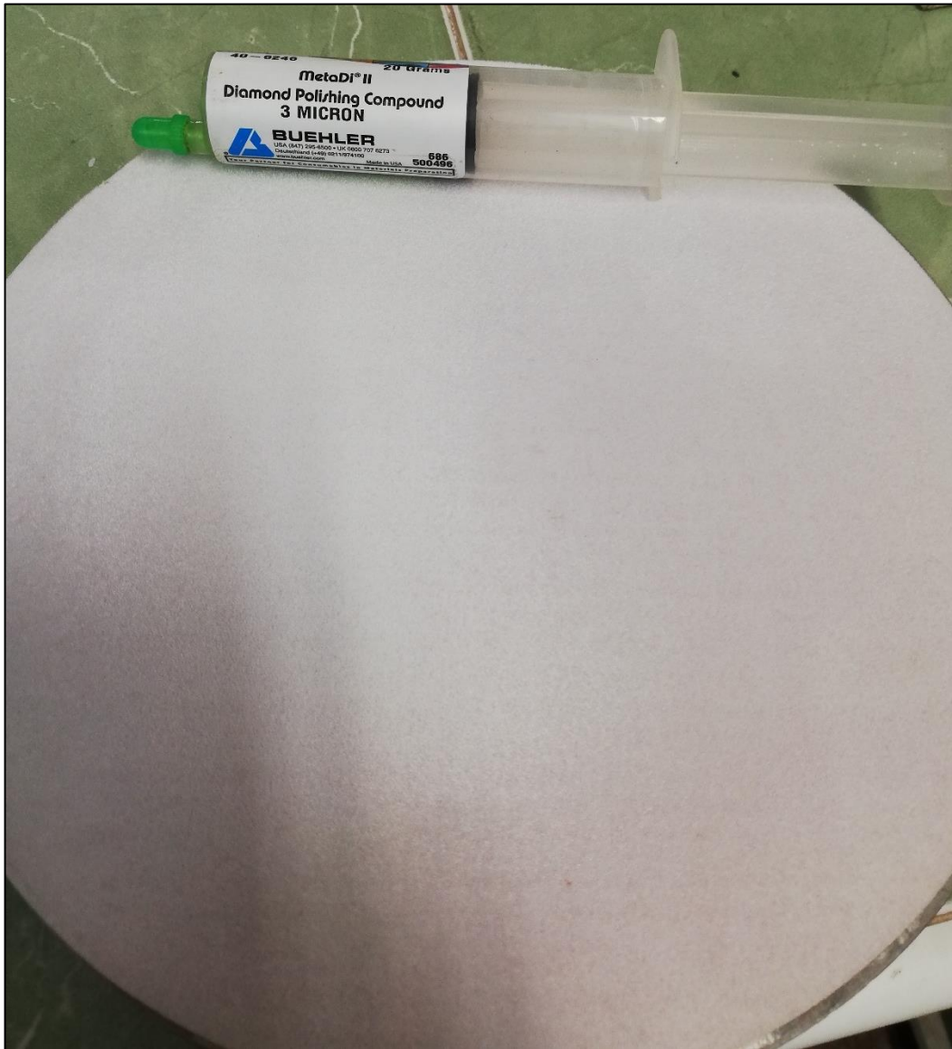
Figura 22.- Paño adhesivo blanco (Texmet 2500 8" PSA) y agregar pasta de diamante (METADI II, Diamond Polishing Compound, 3 micron).
