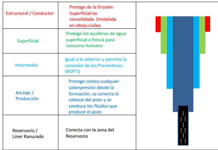
Figura 4. Diseño telescópico de pozos geotérmicos (Fuente: Mayorga, 2018).
