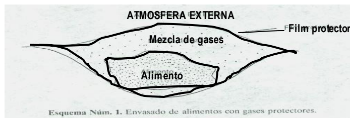
Figura N° 3: Envasado de alimentos con gases protectores
