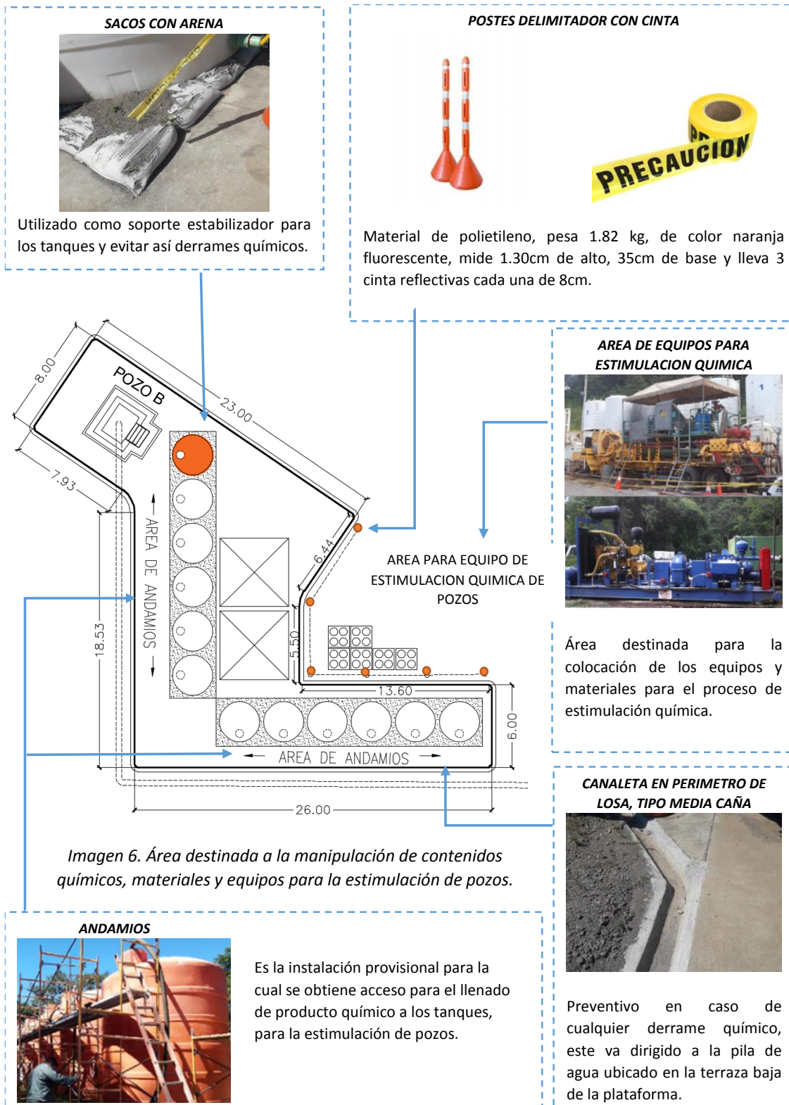
Figura 21: Distribución de espacios en un área para instalar los equipos y materiales de la Estimulación química
