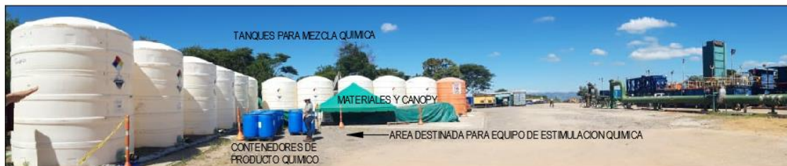
Figura 19: Planta de distribución de áreas dentro de una plataforma de pozos y perspectiva general de área proyectada.
