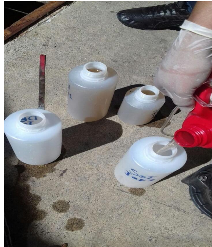
Imagen 9. Muestreo de aguas residuales para análisis Microbiológico y físico químico de planta de tratamiento Quirofanos de Japon.
