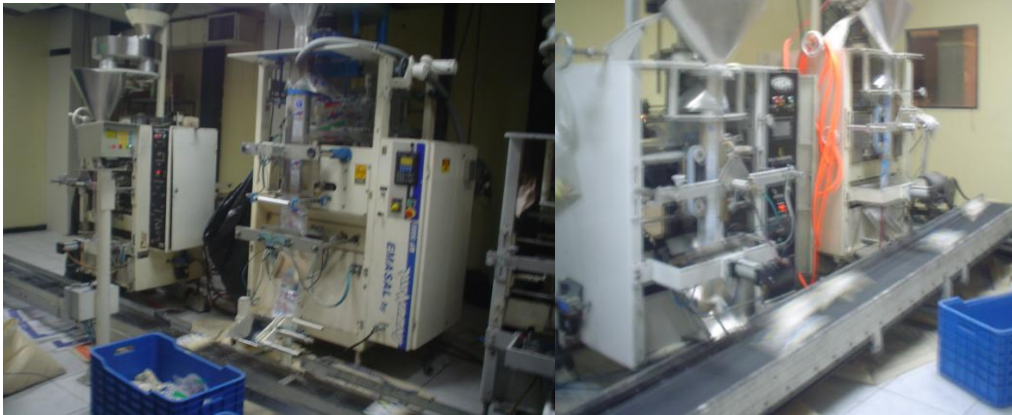
Dosificador de azúcar y tolva de abastecimiento de máquina
