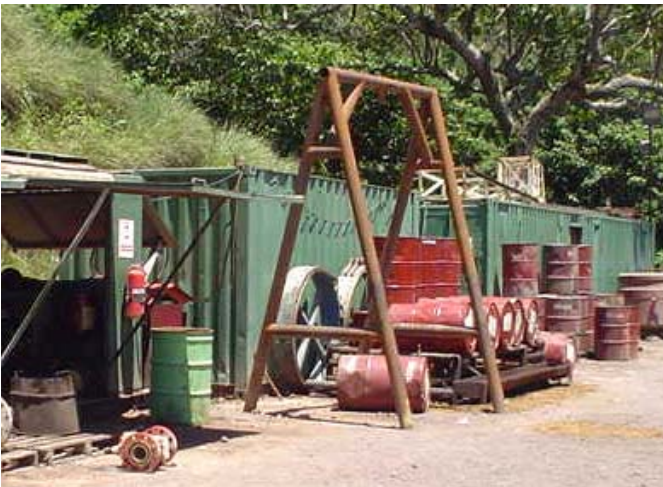
Figura G4. El aceite residual del proceso se recoge en barriles. El aceite es vendido a otras empresas que lo utilizan como combustible. Es importante hacer notar que la disposición final de este residuo debe ser cuidadosamente estudiada
