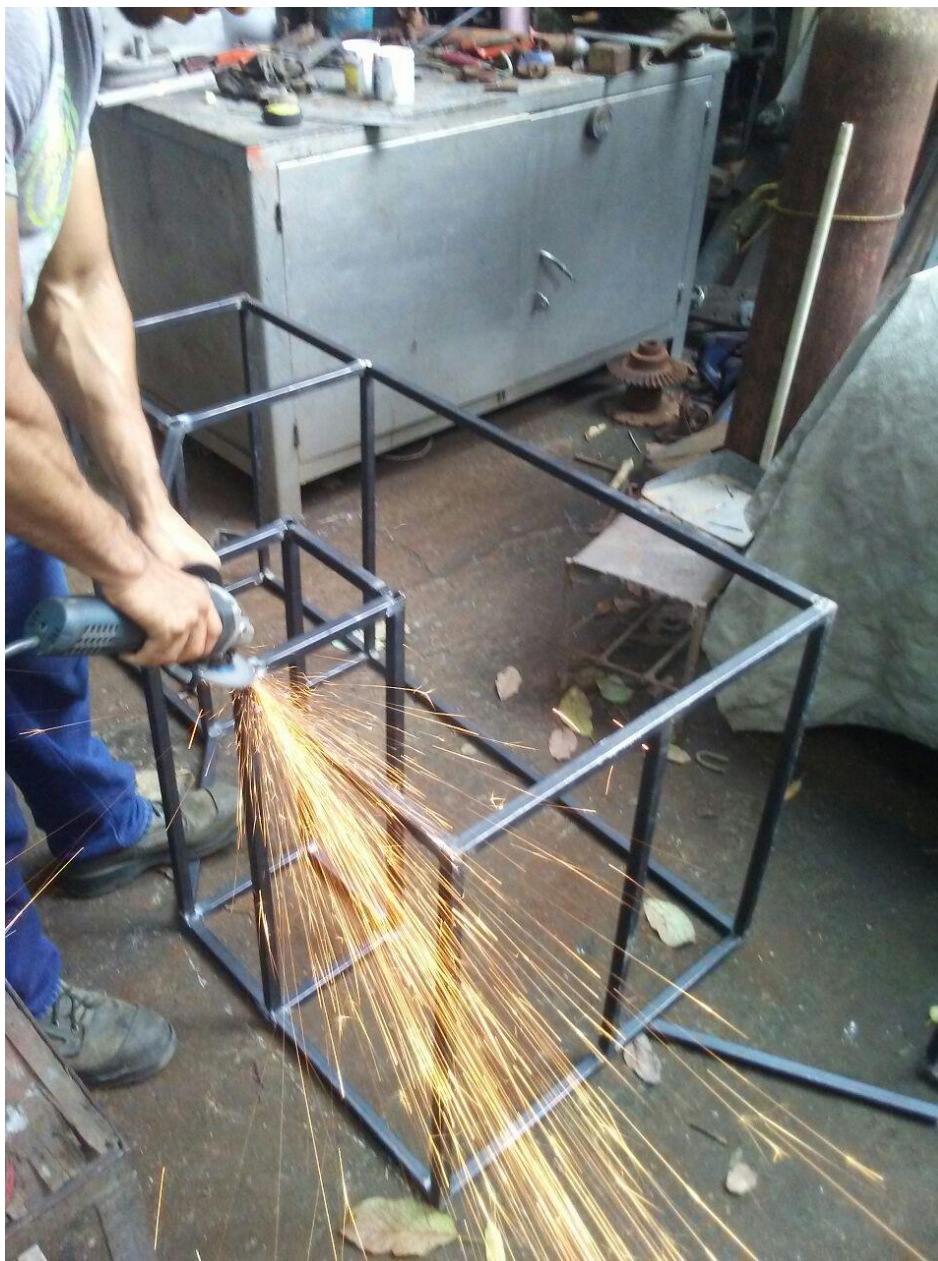
Figura 34. Proceso de ensamble de base metálica. Fuente: imagen propia
