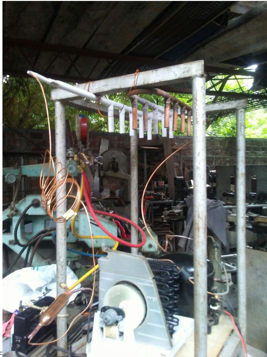
Figura 32. Sistema provisional para pruebas de funcionamiento y calidad del evaporador. Fuente: imagen propia
