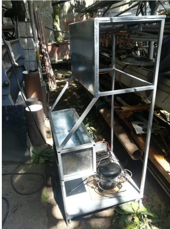
Figura 36. Evaporador y demás elementos colocados. Fuente: imagen propia.
