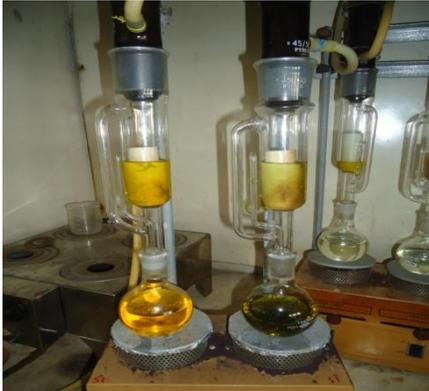
g) Equipo de reflujo soxhlet: equipo para determinación de grasa por extracción con éter.
