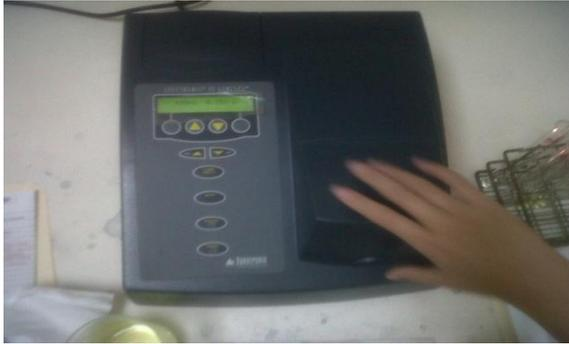
d) Espectrofotometro Spectronic 20, modelo Genesis: equipo para determinación de Fosforo.
