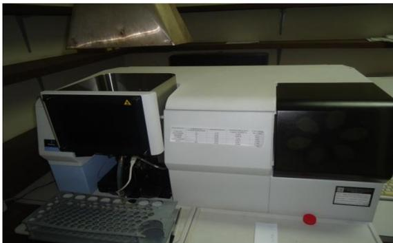
f) Espectrofotómetro de Absorción Atómica, Perkin Elmer Instrument, modelo AAAnalyst 300: equipo para la determinación de calcio y hierro.
