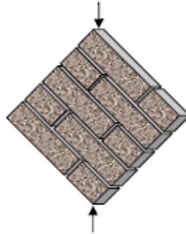
Figura 2.6: Prisma para ensayo de tensión diagonal
