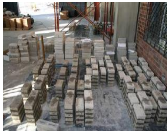
Figura 1.8: Prismas a ser ensayados en primera etapa del proyecto TAISHIN. Fuente: Informe Técnico Suelo-cemento
