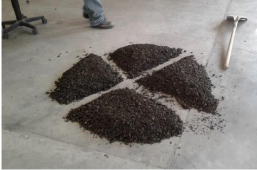
Figura 3.26: Reducción de muestra de agregado grueso a tamaño de ensayo
