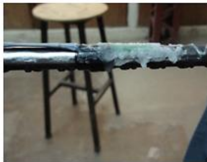
a) Impermeabilización con parafina derretida
