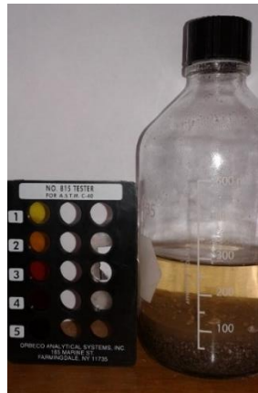
Figura 3.27: Comparación del color de la mezcla según ASTM C40
