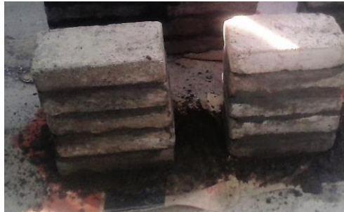
Figura 3.22: Prismas de compresión simple
