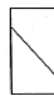
Tipo 4 Fractura diagonal sin fisuras a través de los extremos; golpee suavemente con un martillo para distinguir el Tipo 1
