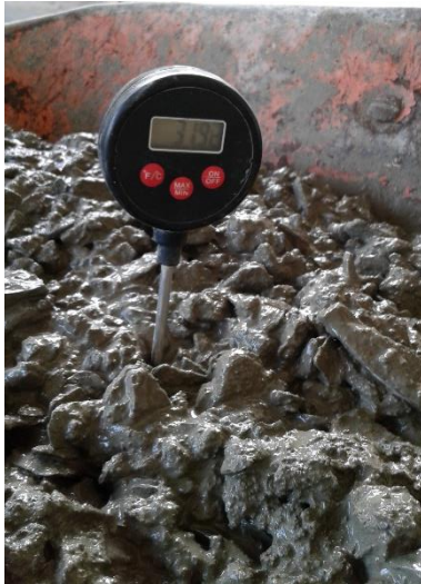
Figura 3.29: Toma de temperatura a bachada de prueba
