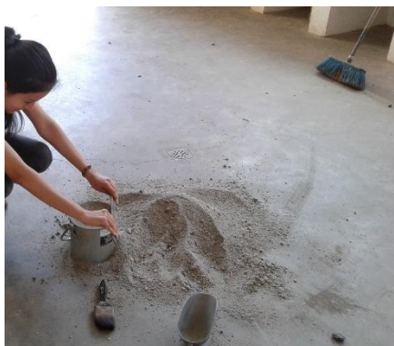
Figura 3.28: Enrasado de recipiente para determinación de densidad Bulk
