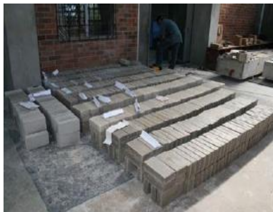
Figura 1.7: Ladrillos producidos para la primera etapa del proyecto TAISHIN. Fuente: Informe Técnico Suelo-Cemento
