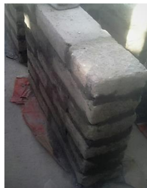
Figura 3.23: Prismas de compresión diagonal
