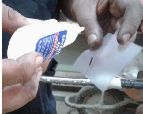
Figura 3.11: Aplicación del adhesivo instantáneo
