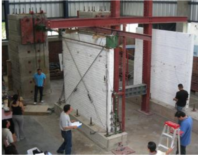
Figura 1.9: Ensayos con carga paralela al plano realizado durante la segunda etapa del proyecto TAISHIN.
