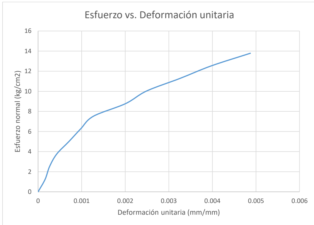
Gráfico 3.2: Esfuerzo vs. Deformación PCS-2
