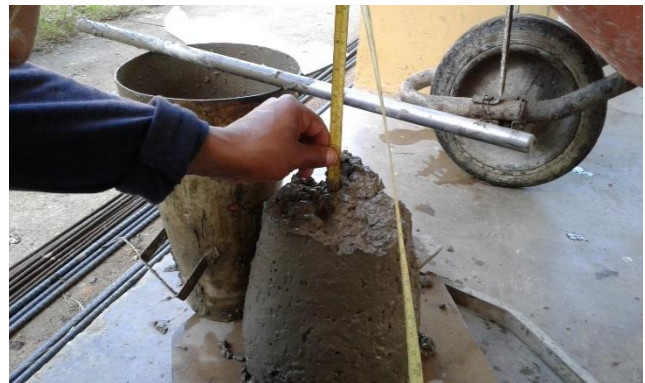
Figura 3.30: Ensayo de revenimiento en bachada de prueba
