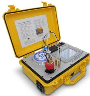
*Figura IV. 3. Transport X para análisis de gases disueltos.*
