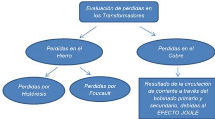
*Figura I.3. Diagrama esquemático para la evaluación de pérdidas del transformador.*
