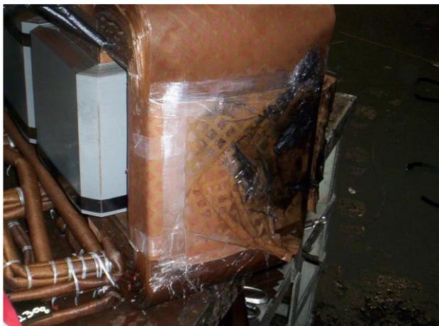
*Figura III.4 Falla en bobina y núcleo de transformador.*
