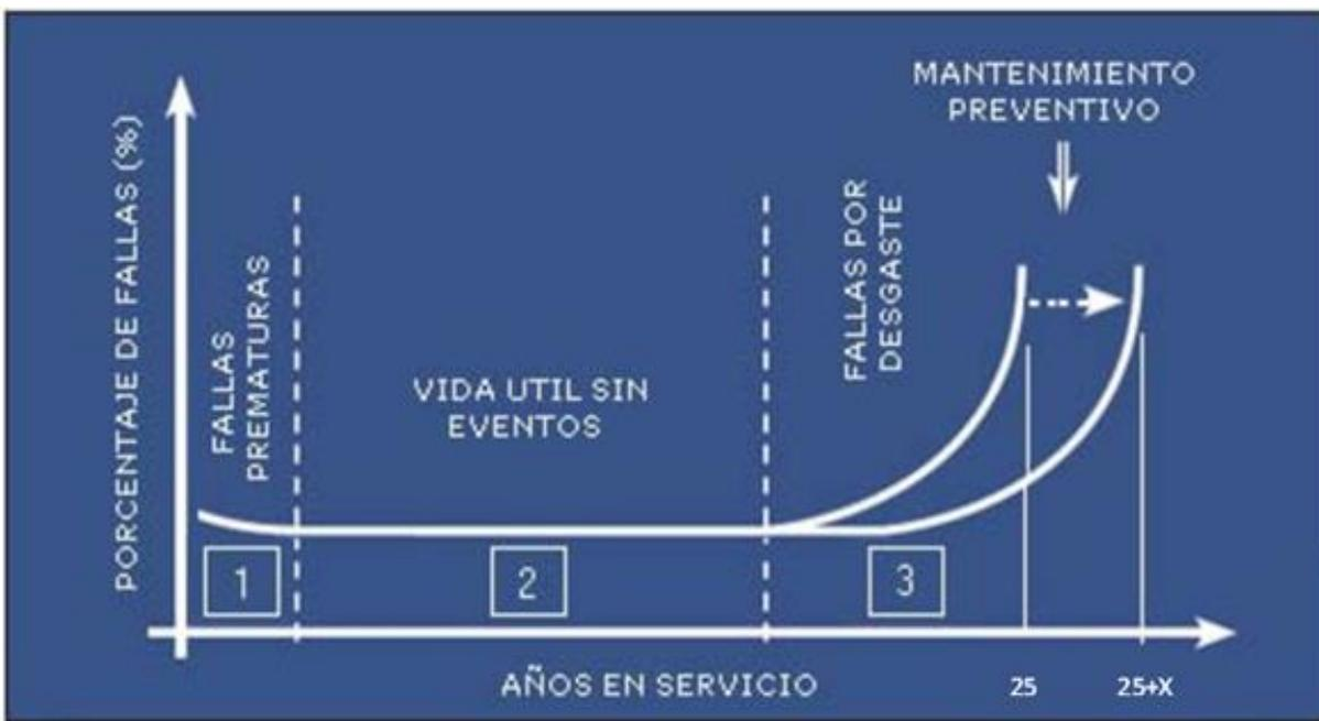
*Figura III.2. Bath curve Típica*
