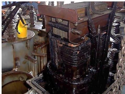
*Figura III.10. Devanado de alta y baja tensión sobrecargados.*
