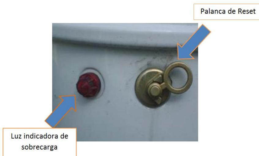
*Figura III.7. Luz indicadora de sobrecarga.*
