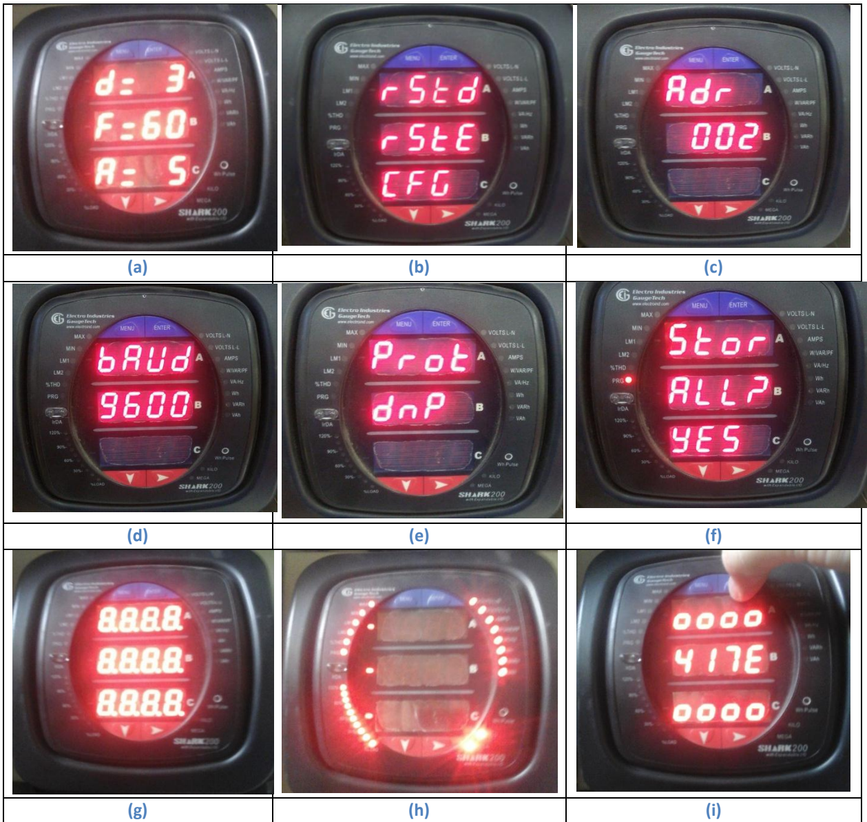
Figura 2. Configuración de medidores. (a) Pantalla inicial de los medidores luego de encenderse. (b) medidor preparado para recibir posibles configuraciones. (c) Variación de la dirección del medidor. (d) Variación del Baud Rate del medidor. (e) Variación del protocolo de comunicación del medidor. (f) Medidor listo para resetearse y guardar los cambios aplicados. (g)(h)(i) Imágenes que muestran la forma de reinicio del medidor.
