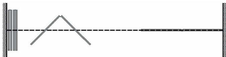
IMAGEN 62: Sistema de desplazamiento unidireccional. Fuente: paredes móviles acústicas, Sonoflex
