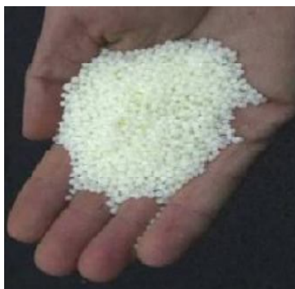
Fig. 3.2d Apariencia del aditivo (cera) granulado. Sasobit
