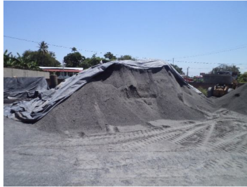
Fig. 3.22c Acopio de agregado (chispa)
