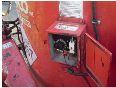
Fig. 3.27a Controlador de la temperatura de calentamiento
