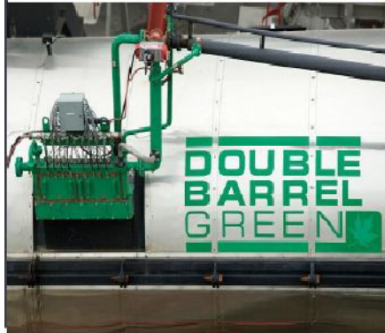
Fig. 3.7d Sistema de inyección del asfalto en forma de espuma
