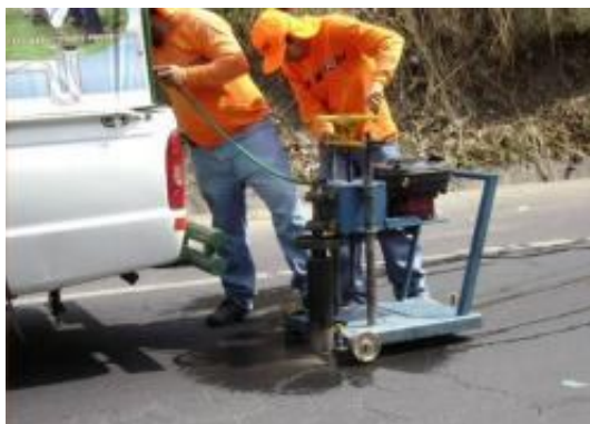
Fig. 3.33a Extracción de núcleo
