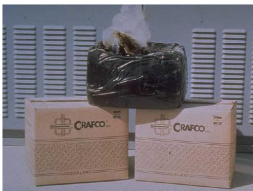
Fig. 3.24a Recepción del material de sellado
