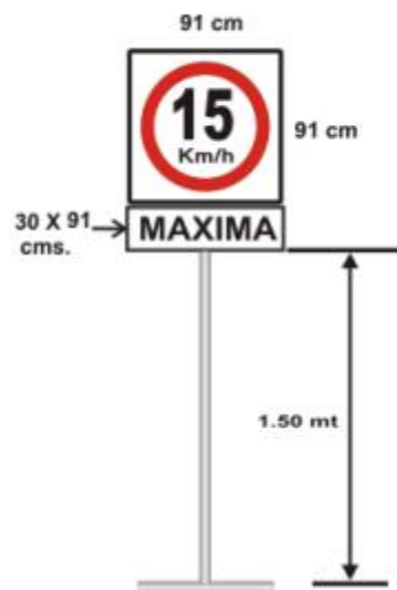
Fig. 5.14 Señal de reglamentación sugeridas por FOVIAL
