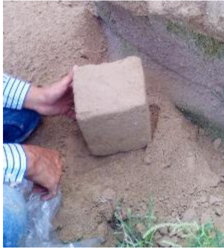
Figura No. 2.2.5 En la fotografía izquierda se observa una muestra inalterada de la unidad D obtenida de la quebrada El Arenal Seco, y la fotografía derecha muestra una sección de un talud que contiene a la Unidad E y la Ignimbrita Alfa en la misma zona.
