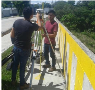
Figura No. 4.7.20 Colocación del receptor fijo en la estación de referencia de coordenadas conocidas Fuente: EL AUTOR, fotografía tomada el 31/08/2017
