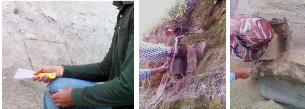
Figura No. 4.8.1 Proceso aplicado para la obtención de muestras inalteradas; en la imagen del costado izquierdo se muestra la selección de la zona del talud donde se extraerá la muestra, en la imagen central se muestra el proceso de tallado para dar una forma regular a la muestra, y en la imagen del costado derecho se aprecia la forma en que se debe de extraer la muestra para evitar alterar las características de esta.
