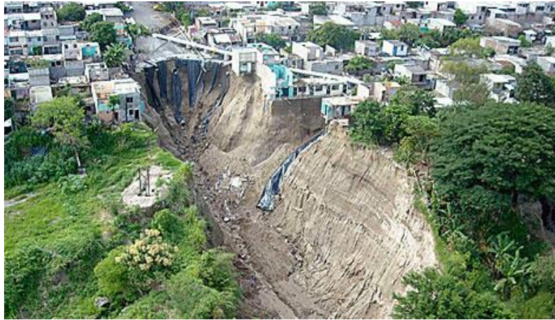
Figura No. 2.5.4 Cárcava generada en el reparto Las Cañas, Ilopingo, debido a las lluvias registradas por la tormenta tropical Agatha en el año 2010. Fuente: Mendoza, (2016). "FENÓMENO DE EROSIÓN EN LOS SUELOS"
