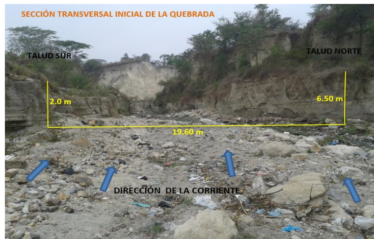
Figura No. 4.6.5 Esquema de la dirección de la corriente del agua con respecto al borde de los taludes; además, del ancho del cauce y las alturas aproximadas de cada talud. Fuente: EL AUTOR, fotografía tomada el 3/2/2017.
