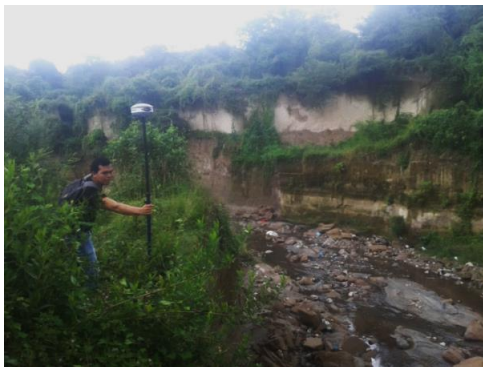
Figura No. 4.7.21 Colocación del receptor móvil en los puntos ubicados en cada talud y en el borde de estos. Fuente: EL AUTOR, fotografía tomada el 31/08/2017
