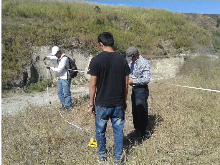
Figura No. 4.7.2 Trazo de la cuadrícula en la superficie del talud. Fuente: EL AUTOR, fotografía tomada el 6/3/2017
