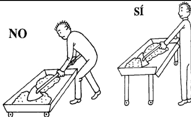
Figura E .Ajuste de altura de la zona de trabajo a la cadera.
