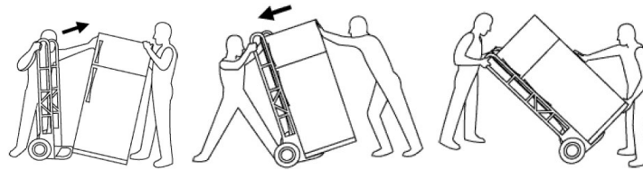
Ilustración IV 55- Trabajo en equipo para manipulación de carretillas.
