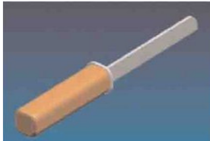
Figura H. Diseño de herramienta manual para partir ladrillos.
