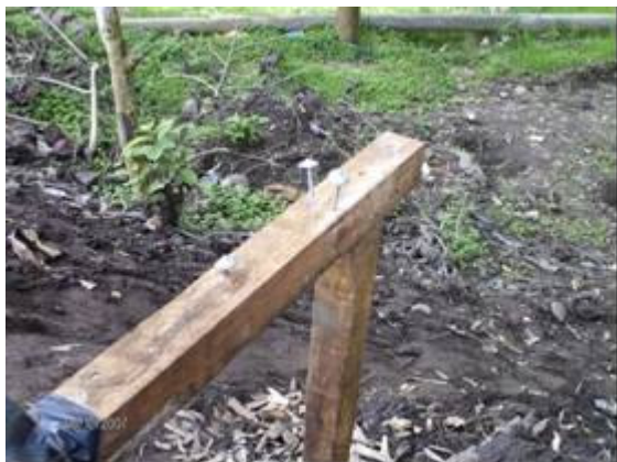
Fotografía 173- Trazo para doblado de varillas de hierro Trazo provisional hecho con clavos
