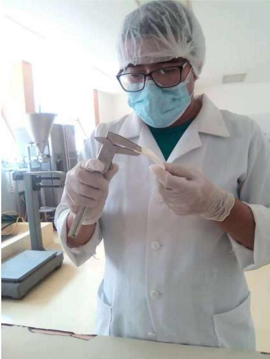
**Figura a.6.3.2:** Medición del espesor de las rodajas de yuca para la elaboración de harina de yuca.
