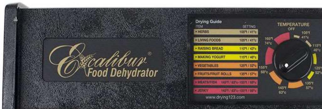
**Figura 5.7:** Termostato para control de temperatura del Deshidratador eléctrico EXCALIBUR 3900B del Laboratorio de Tecnología de Alimentos de la Escuela de Ingeniería Química e Ingeniería de Alimentos (FIA-UES)
