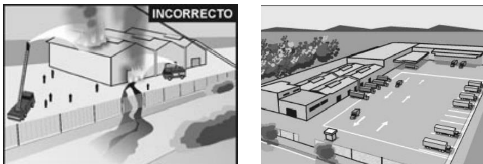
Figura 6 Ubicación inadecuada de la bodega y vista de un sitio de almacenamiento (Minambiente, 2006).
