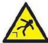
Caida a distinto nivel
