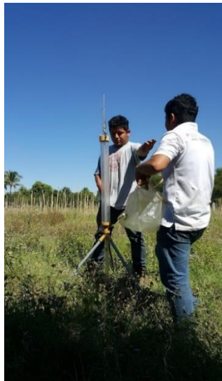
Fig. 1.8 Permeámetro de Guelph siendo utilizado durante una prueba en el área de estudio.
