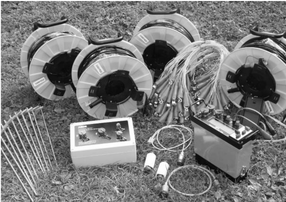
Fig. 1.5 Equipo utilizado para realizar tomografías eléctricas. (ABEM, 2010)
