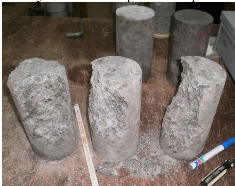
Fotografía A6.6: Fallas de especímenes a compresión
