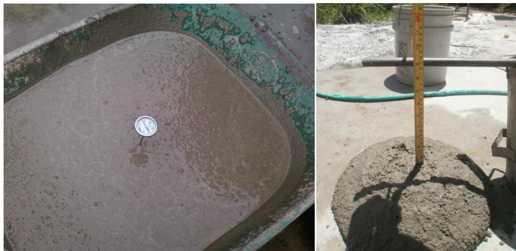
Figura N° 4.28: Mezcla luego de correcciones por agregados y humedades con aditivo HRWR
