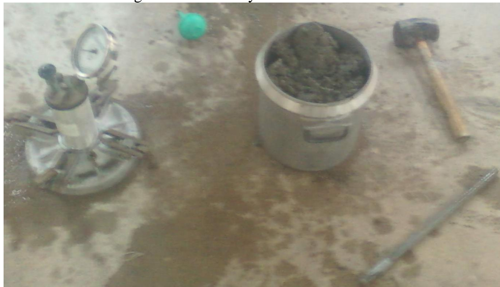
Fotografía A6.4: Ensayo de Contenido de aire
