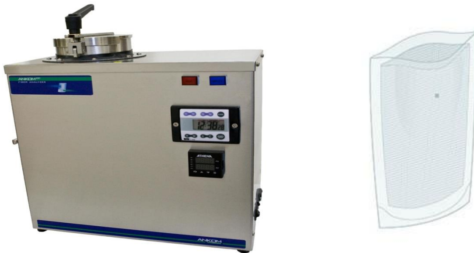
Figura A- 7. Equipo para determinación de fibra en muestras de Moringa (Moringa oleífera Lam) utilizando proceso de digestión.
