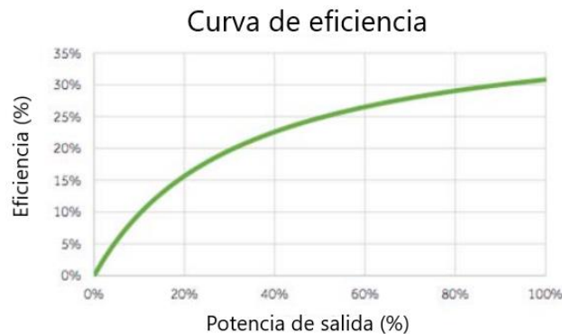
Figura 1.9 Eficiencia típica de un motor Diésel a partir de la potencia de salida requerida a velocidad constante [11].
