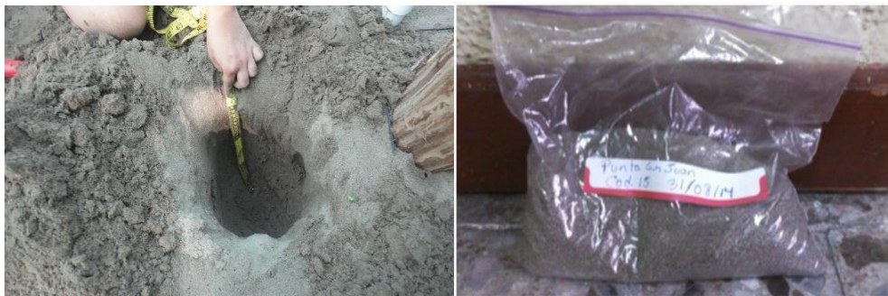
Figura 5. Agujero a 30cm de profundidad y muestra sellada y etiquetada
