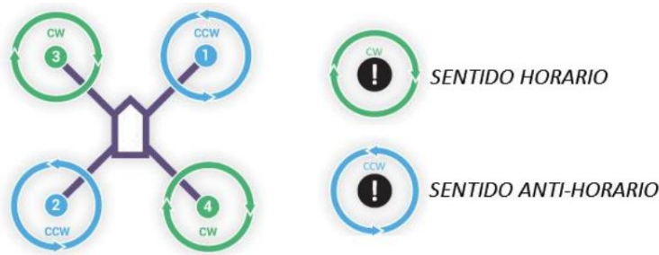
Figura 2. Configuración en "X".
