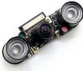
Figura 7. Cámara Pi V1 modulo "H".
