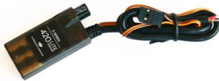
Figura 10. Controlador electrónico de velocidad 420 lite.
