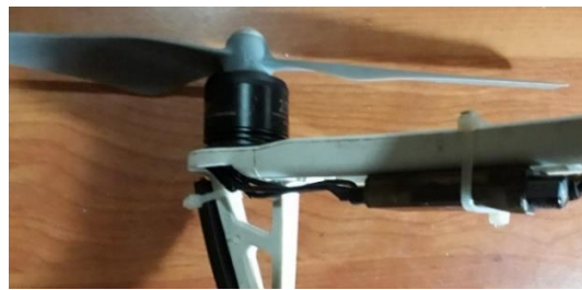
Figura 21. Montaje sistema de propulsión E305.
