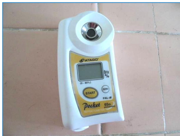
Fotografía 26 Brixómetro usado para determinar el porcentaje de sólidos totales
