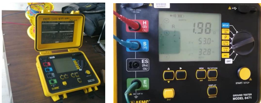
Figura 3. 2 Resultado de la medición de la red de tierra fue de los 1.98Ω
