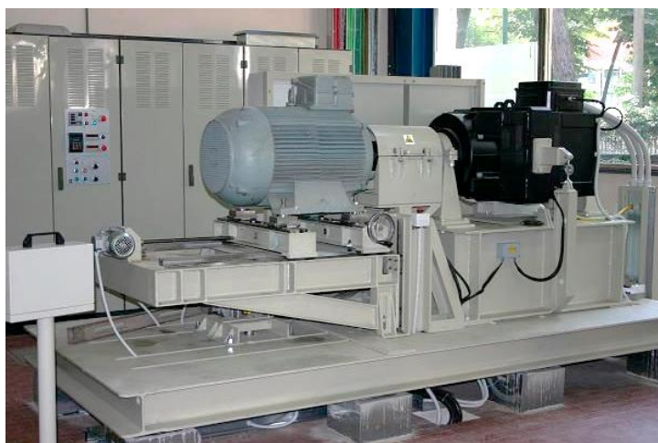
Figura 3. 6 Banco de pruebas conforme a los definidos por las normas IEEE 1068, IEEE-112 e IEC60034-1.
