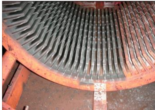
Figura 2. 8 Este núcleo ha sido parcialmente limpiado con una lavadora de alta presión.
