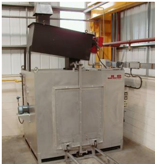
Figura 2. 7 Horno de quemado con temperatura controlada.
