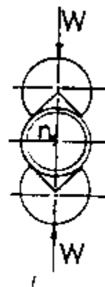
FIG. 6b. La varilla cilíndrica se recubre con una película de aceite.
