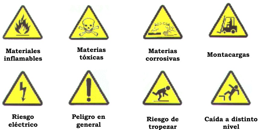
Figura 150. Señales de Advertencia.
