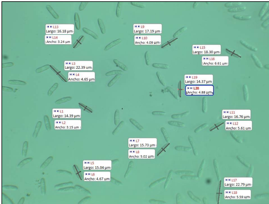
Figura 23. Medidas del largo y ancho (µm) de conidias de C. gloeosporioides , aislada de hoja, con un microscopio Motic óptico con cámara incorporada; imagen captada con el programa Image Plus 2.0. Vista a 40 X.
