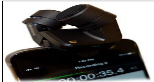
Figura 9. Ejemplo de micrófono externo para teléfono inteligente (Macaulay library 2017).
