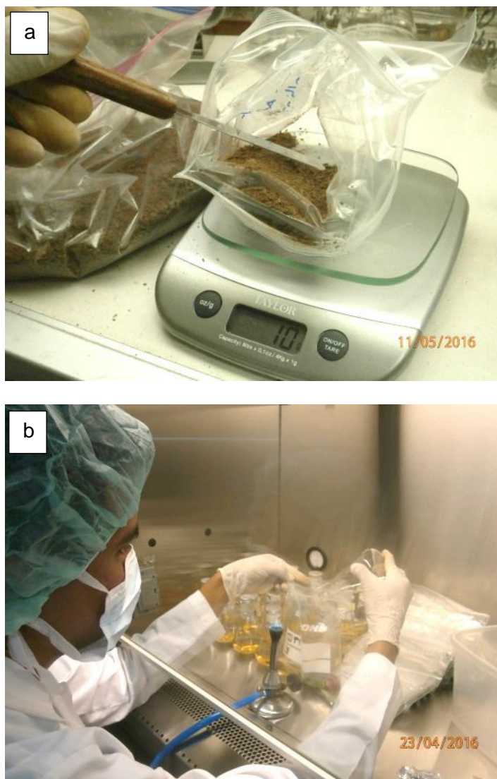
Figura 40. a) Pesaje de bocashi y b) vaciado de Caldo Lactosado para la identificación de Salmonella spp.
