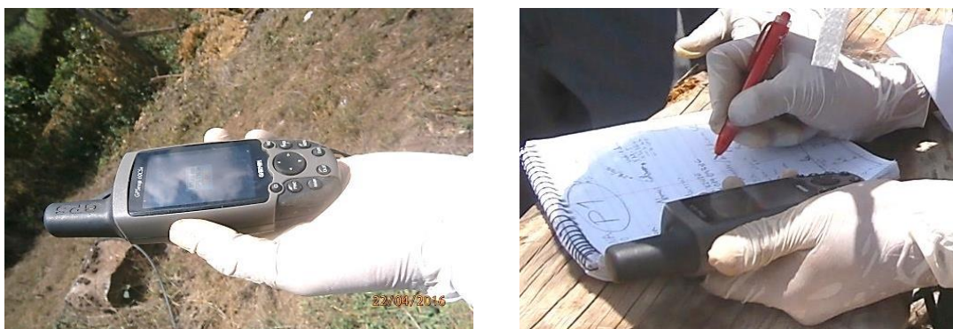
Figura 23. Georreferenciación de la ubicación de las parcelas de los productores mediante GPS.
