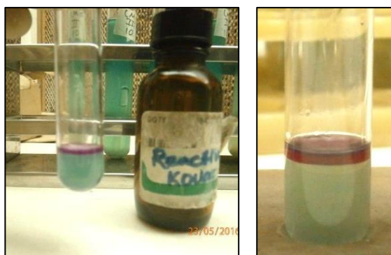
Figura 9. Detección de indol con reactivo de Kovac (anillo rojo) como prueba confirmatoria de presencia de E. coli (de izquierda a derecha).
