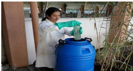
Figura 12. Muestreo de agua residual en la entrada del humedal artificial.
