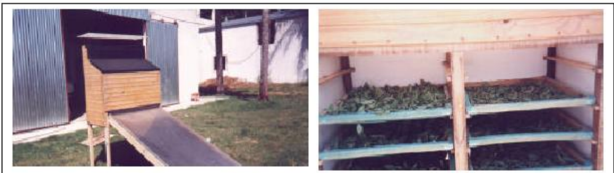
Figura. 6.14 Vista del secador solar y detalle del interior de la cámara de secado.
