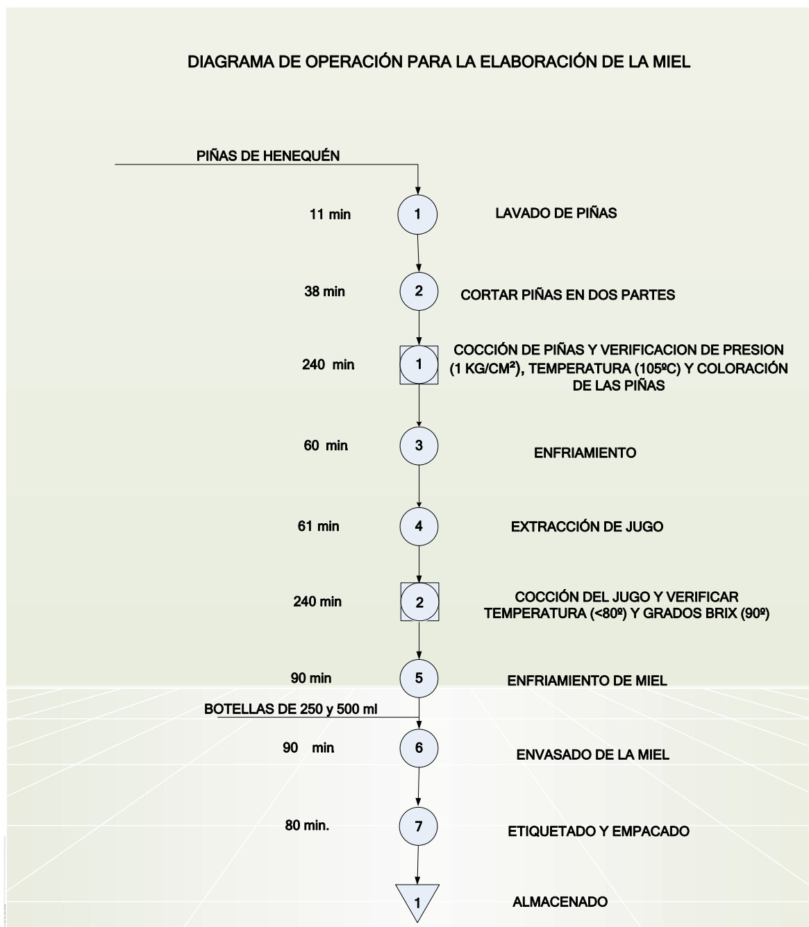
Fig. 16: Diagrama de operaciones para la elaboración de la miel.
