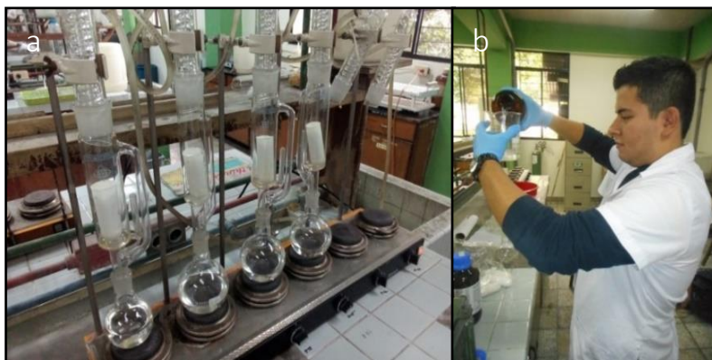
Figura 21. a) Evaporación y condensación de éter en muestras de cacao para calcular grasa, b) recuperación del éter sobrante después de completar la evaporación y condensación.
