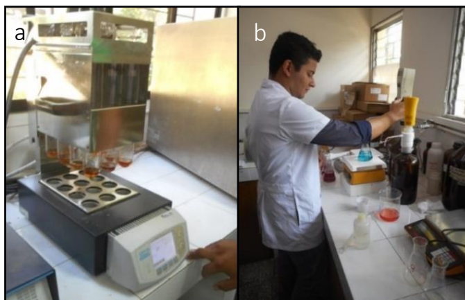
Figura 22. a) Destrucción oxidativa de los componentes por calentamiento con ácido sulfúrico concentrado, b) titulación de sal amoníaca con solución ácida estandarizada.
