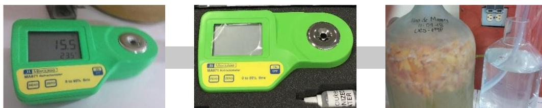
Figura A - 4. Determinación de grados Brix
