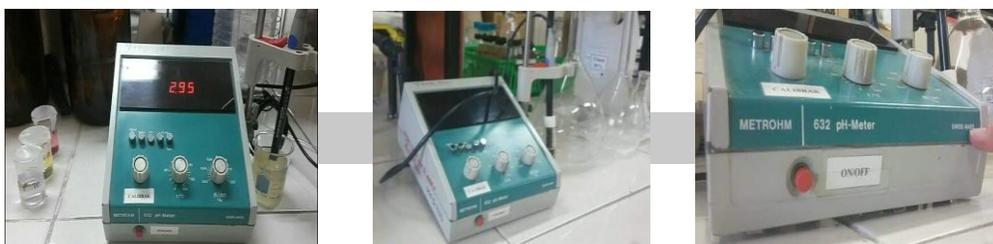
Figura A - 2. Determinación de pH según AOAC.
