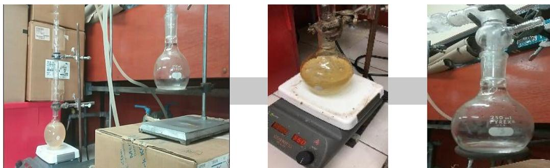
Figura A - 5. Determinación de grado alcohólico, según AOAC 11.006
