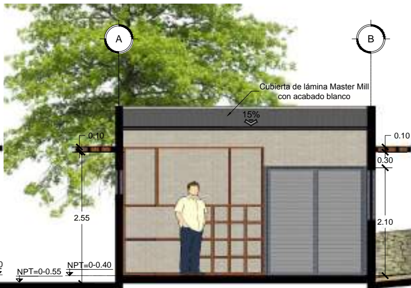
CORTE ARQUITECTÓNICO B-B ÁREA DE MANTENIMIENTO ESC 1:75
