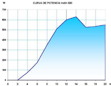
Fig. 7: Curva de Potencia para el aerogenerador Inclín 600. Fuente: Bornay.
