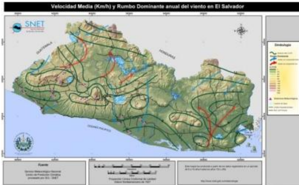
Fig. 5: Velocidad Media y Rumbo Dominante anual del viento en El Salvador (1 km/h = 0.278 m/s). Fuente: SNET.
